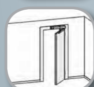
Montaj pe buiandrug pentru 1 canat, sens ușă DIN stânga sau dreapta, braț culisant, acționare prin tragere.
