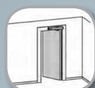
Montaj pe buiandrug pentru 1 canat, sens ușă DIN stânga sau dreapta, braț articulat standard, acționare prin împingere.
