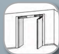
Montaj pe buiandrug pentru 2 canaturi cu trafic în 2 sensuri cu 2 operatori independenți.
