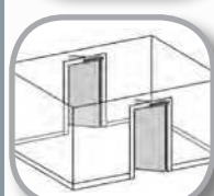
Operare sincronizată Interlocare, 2 uși cu un canat
