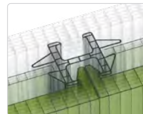
DETALIU DUBLU CONECTOR Detalii cu privire la sistemul de blocare prin profil de îmbinarea dublu.
