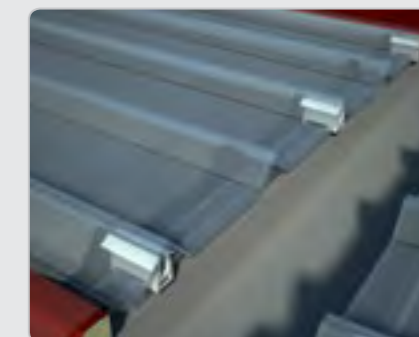
DETALIU STREAȘINĂ Detaliu introducere garnitură PE-LD
